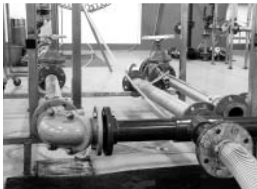
Testowany zawór na instalacji badawczej w położeniu leżącym
